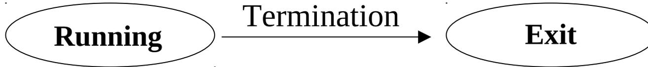
**Exit** stato di rilascio di strutture dati allocate all'atto della terminazione del processo e di gestione delle azioni necessarie ad una corretta terminazione di processo
